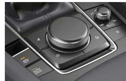
Μονάδα ελέγχου HMI
